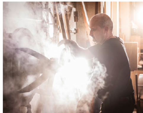
Holzbiegen mit Dampf im Winkler Holzbiegewerk in Felsenau. Foto: Sabrina Golob
